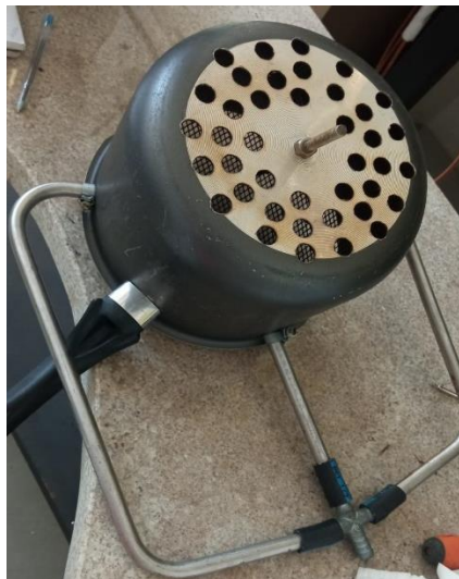
Figura 31 - Primeiro modelo do reator, onde ar comprimido era inserido no tubo de aço
