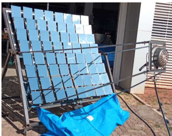
Figura 19 - Concentrador solar de 2,5 metros quadrado com reator no receptor.
