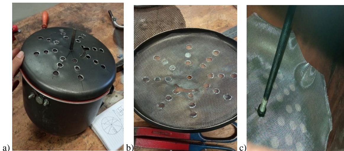
Figura 32 - a) Reator 2 e 3, diferenciando pela abertura da malha das telas. b) Abertura segundo reator c) Abertura terceiro reator.
