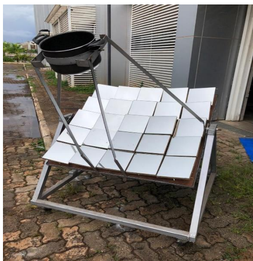
Figura 13 - Concentrador solar de 1m 2 e 25 espelhos, montado na Embrapa Agroenergia.
